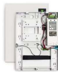
Paxton alimentation 12V 2A DC - coffret ABS
